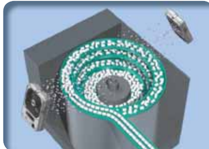
Abbau statischer Elektrizität von Zuführungseinrichtungen Verhindert Verstopfen.
